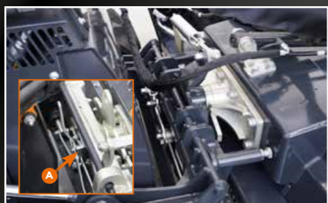
Podnośnik przedni z szybkozłączem i dźwignią zabezpieczającą (A) Front lifter with quick attachment with safety lever (A)
