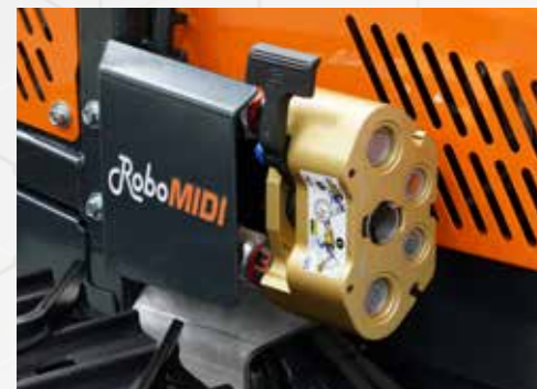
Szybkozłącze CEJN CEJN fast hydraulic couplings
