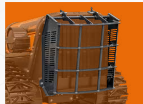
Osłona chłodnicy Steel radiator protection
